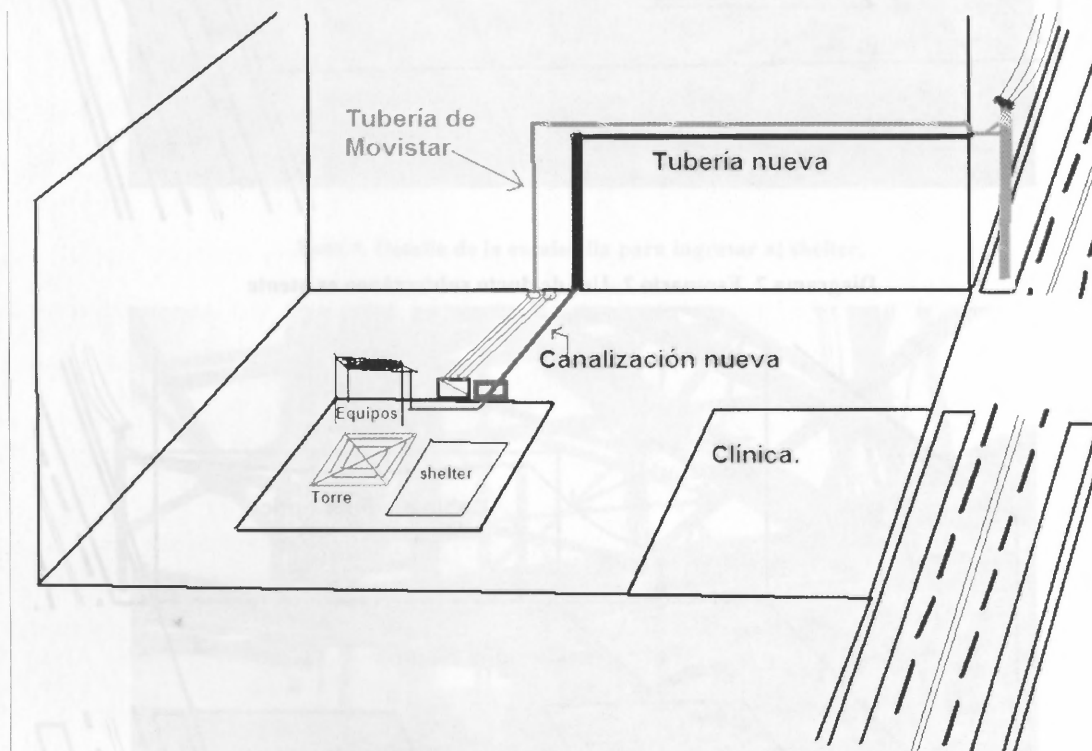
Diagrama 1. Escenario 1. Construir ducto subterráneo atravesando calle privada
