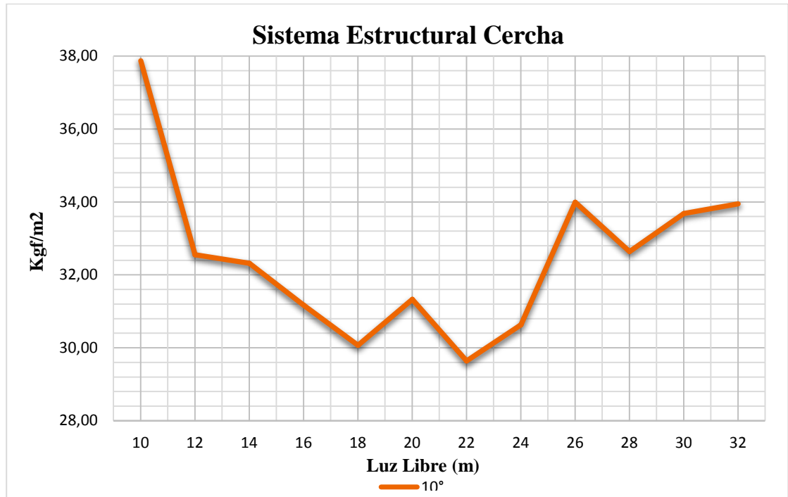
Figura 72. Variación de Kg/m 2 a medida que aumenta la luz libre para un ángulo de 10°. Cerchas con 14 Diagonales Internas. Perfiles Tubulares. Fuente: Elaboración propia.
