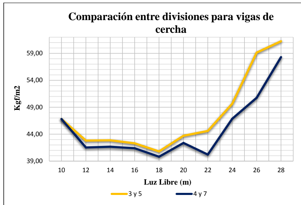
Figura 48. Variación de Kg/m 2 a medida que aumenta la luz libre para distintas divisiones en las vigas superiores e inferiores de cercha. Perfiles Laminados en caliente.
