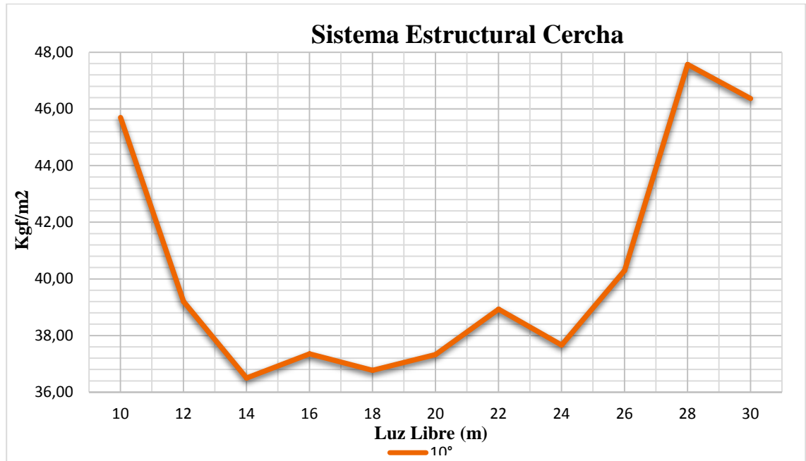
Figura 60. Variación de Kg/m 2 a medida que aumenta la luz libre para un ángulo de 10°. Cerchas con 14 Diagonales Internas. Perfiles Electrosoldados. Fuente: Elaboración propia.
