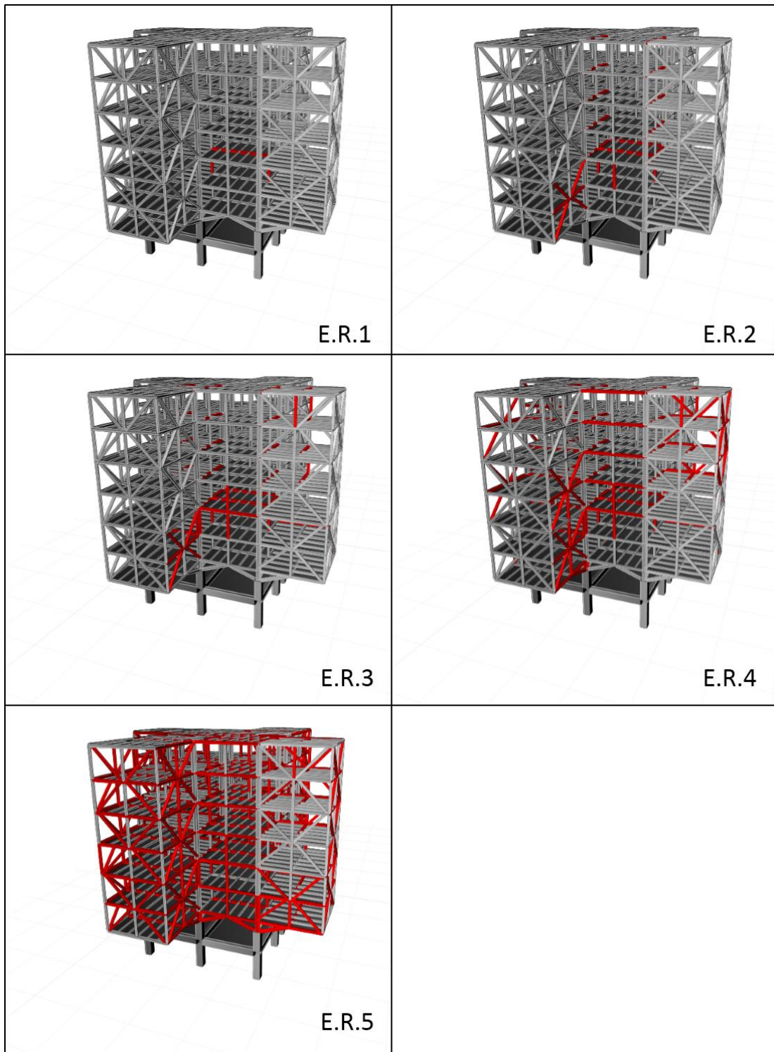
Figura IV-48: Vista en 3D de propagación de la falla. Caso I-Z2-P3
