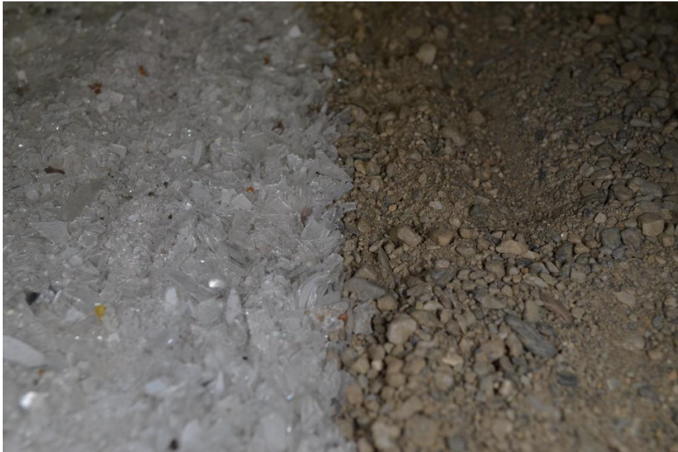
Figura A-4 Imagen comparativa entre los tamaños de partículas del vidrio proveniente de bombillos ahorradores y arena natural de río utilizada en las mezclas de concreto.
