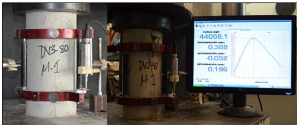
Figura III-6 Ensayo de compresión simple de cilindro con curva tensión-deformación Fuente: Elaboración Propia.
