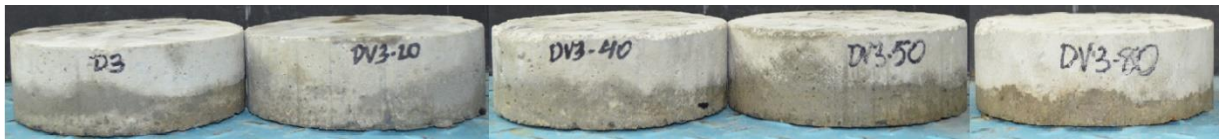
Figura III-7 Resultado físico de la absorción por capilaridad de Fagerlund Fuente: Elaboración Propia.
