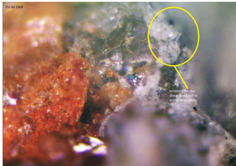
Figura A-2 Microscopía óptica de la interacción pasta de cemento y agregados “Shear Bond” de una muestra de concreto con 80% de vidrio proveniente de bombillos ahorradores y una dosis de cemento de 420 \text{ Kg/m}^3 (Zoom 100X)
