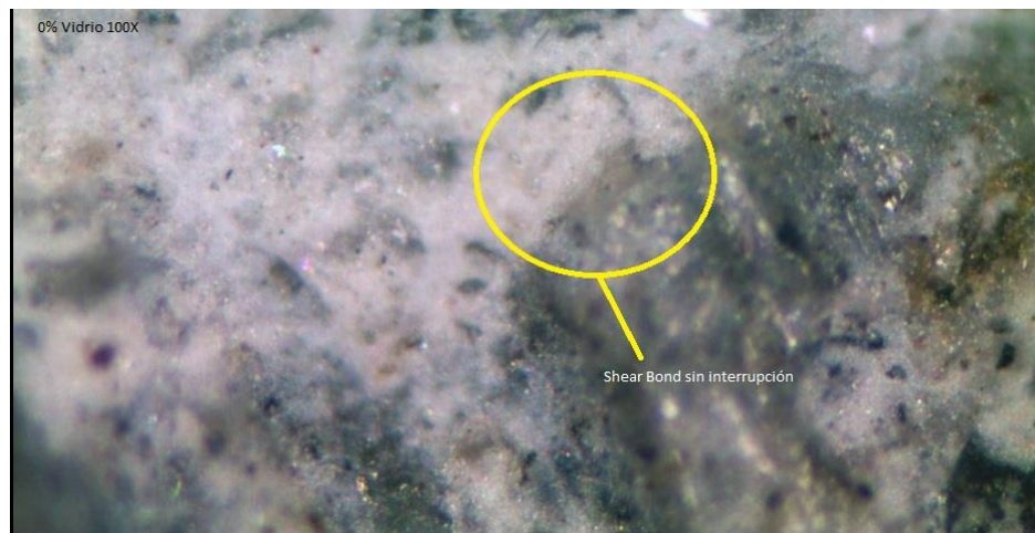
Figura A-1 Microscopía óptica de la interacción pasta de cemento y agregados "Shear Bond" de una muestra de concreto con 0% de vidrio proveniente de bombillos ahorradores (patrón) y una dosis de cemento de 420 Kg/m 3 (Zoom 100X)
