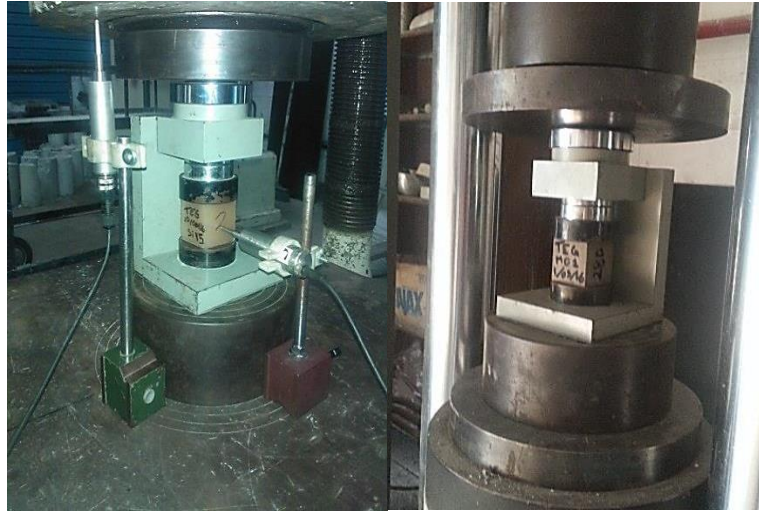
Figura 3- 9 Ensayos a compresión de cubos poliméricos
