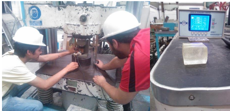
Figura 4- 3 Ensayo a compresión de cubo translúcido
