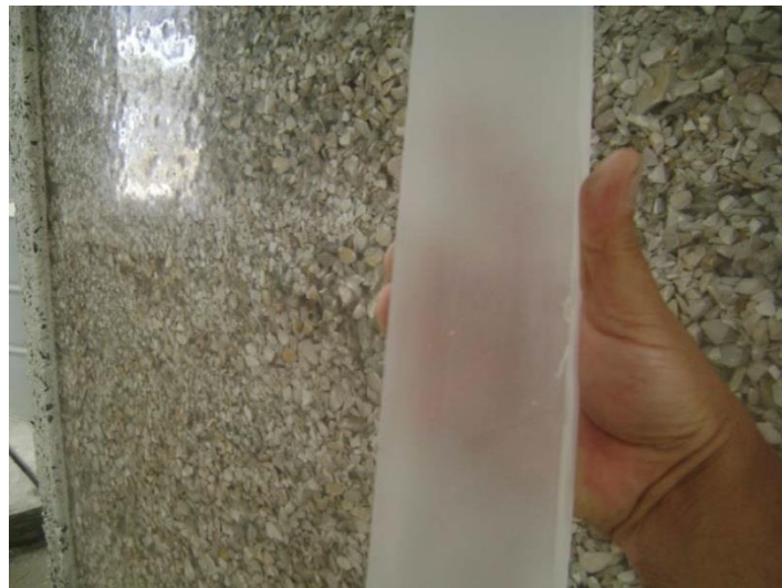
Figura 1- 1 Concreto translúcido “Illum”.
