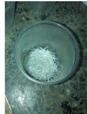
Figura 3- 2 Fibra de polipropileno rizado
