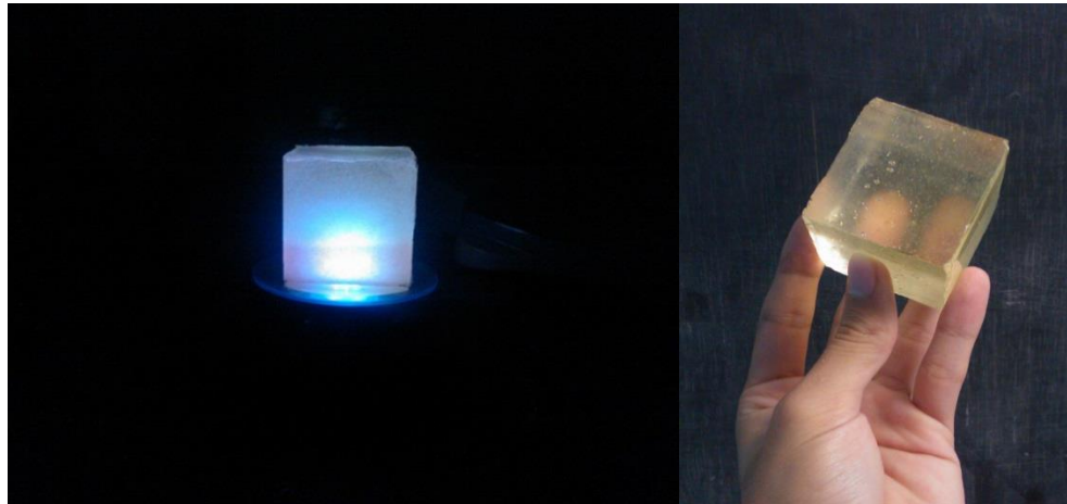
Figura A- 14 Muestra de concreto polimérico con sílice tipo “S” y “CP”
