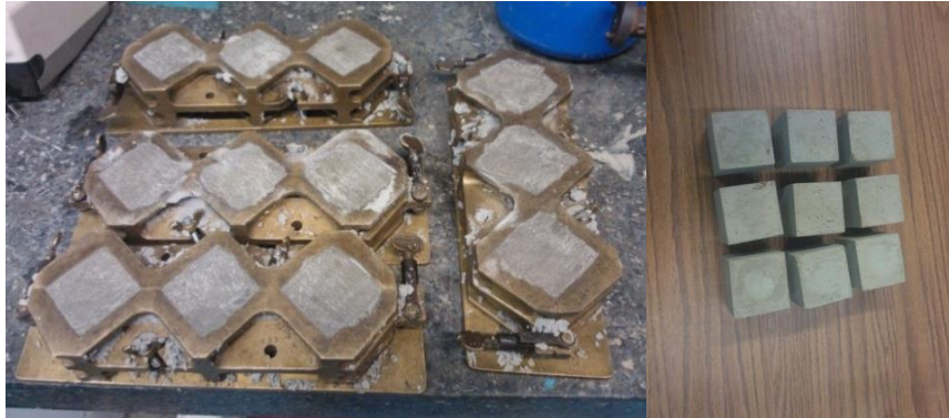
Figura 3- 6 Elaboración de probetas de morteros convencionales
