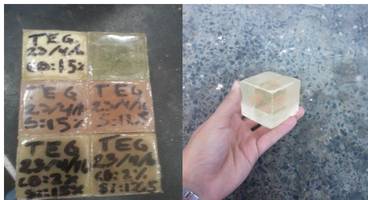
Figura 3- 7 Probetas de concreto polimérico
