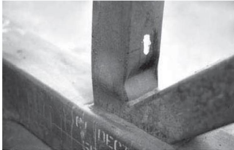
Figura 2- 18 Conexión tipo K de perfil tubular de sección rectangular solapado bajo carga última.
