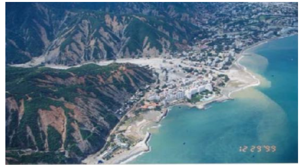
Figura 18. Fotografía de los deslizamientos superficiales de la cuenca baja del Río Cerro Grande después de los deslaves de Vargas de 1999, Venezuela
