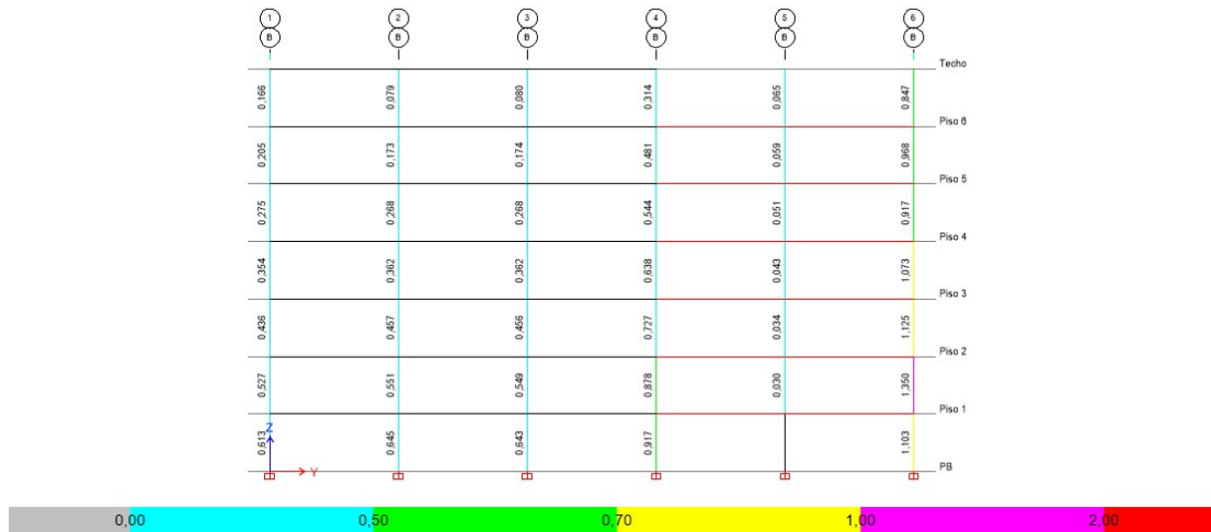
Figura IV-69. Relación Demanda-Capacidad de vigas y columnas influenciadas en el pórtico B para el caso de estudio PB-B5, en el edificio de 6 pisos. Fuente: Elaboración propia.
