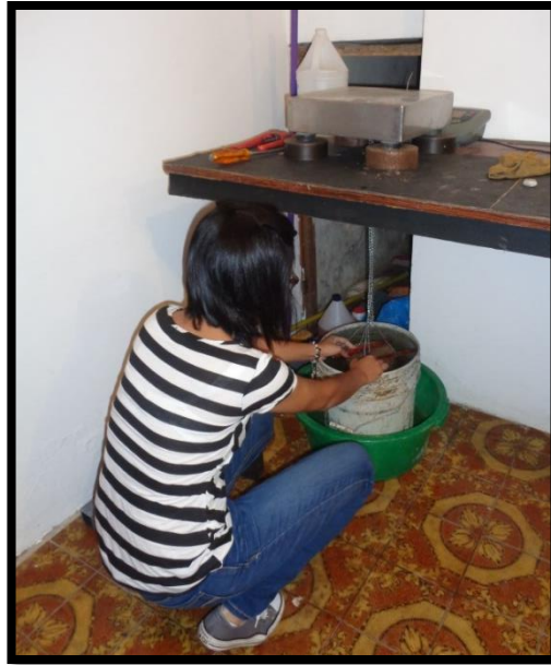
Figura 3.15- Medición de Peso Sumergido Fuente: Propia
