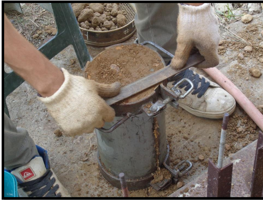
Figura 3.11- Enrasado de la superficie de las probetas. Fuente: Propia
