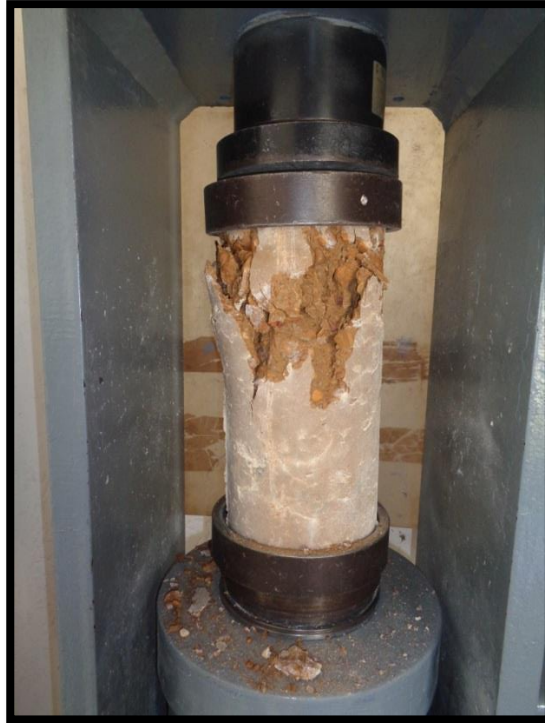
Figura 3.14- Falla de Probeta C-3 (Diseño D-001). Fuente: Propia
