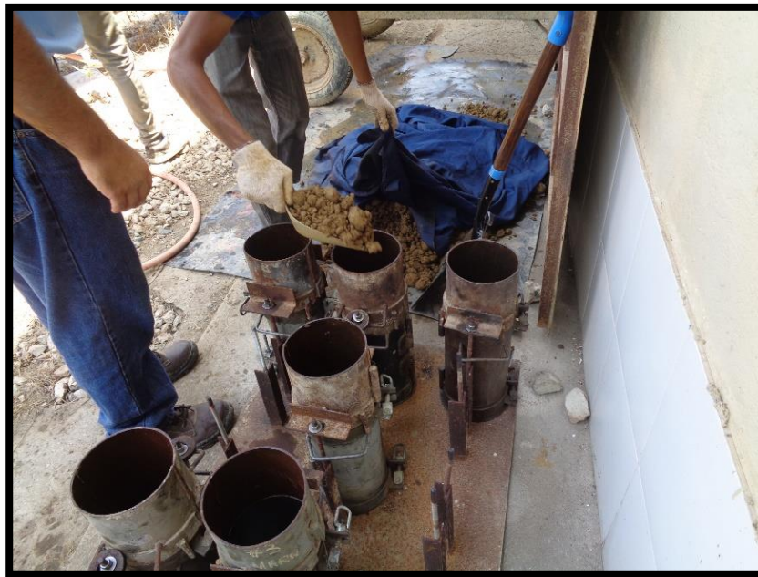
Figura 3.10- Colocación de las capas de RCC en las “conchas”.
