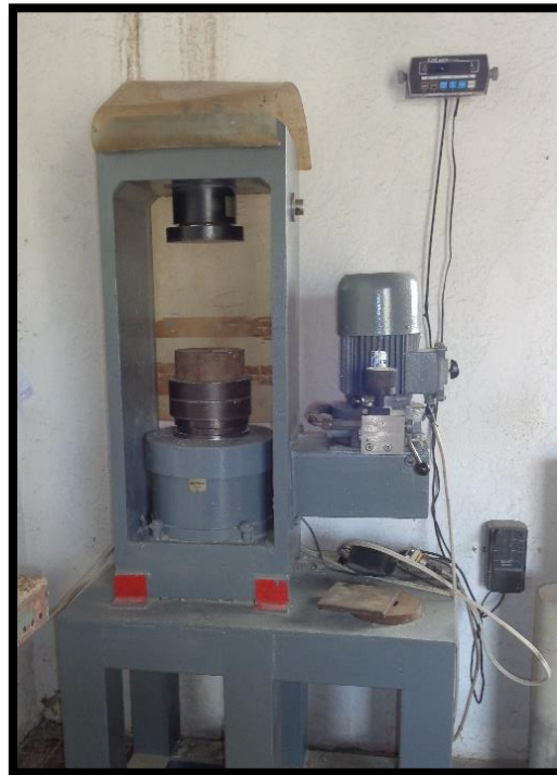
Figura 3.3- Compresor Hidráulico. Fuente: Propia.
