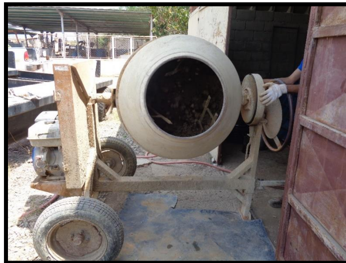
Figura 3.4- “Trompo” Mezclador. Fuente: Propia.
