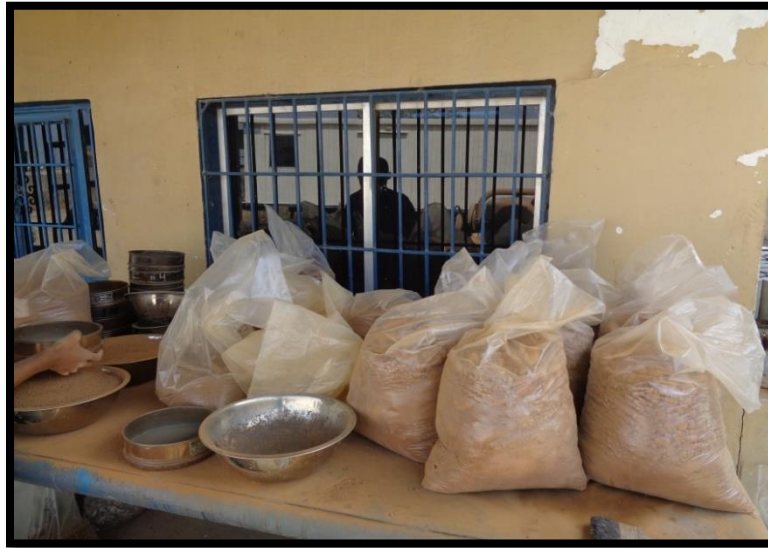
Figura 3.9- Material Tamizado y Sellado por tamaño. Fuente: Propia
