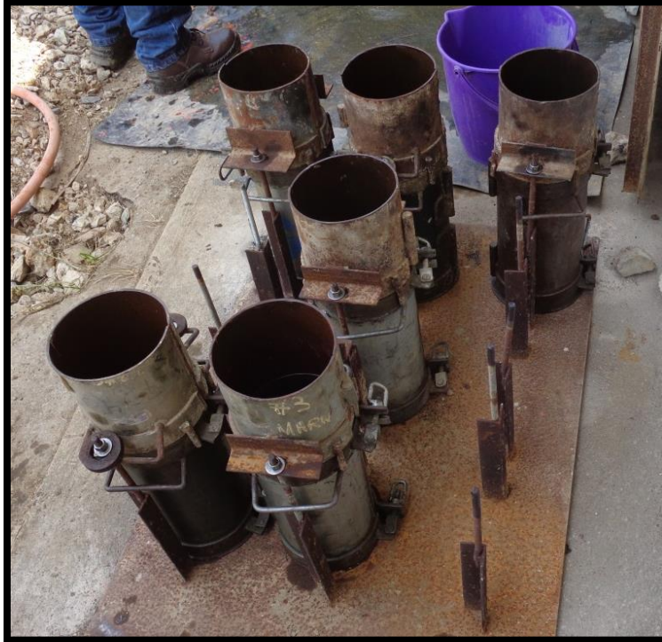
Figura 3.5- Moldes Cilíndricos (“Conchas”). Fuente: Propia
