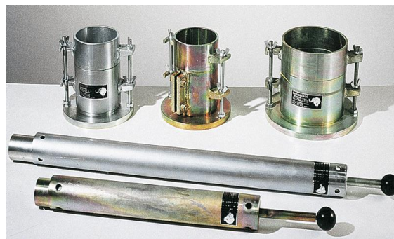
Figura 2.2- Equipo utilizado para realizar Proctor Modificado.
