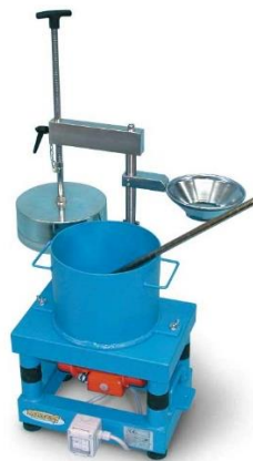
Figura 2.3- Equipo utilizado para realizar Ensayo VeBe. Fuente: http://proetisa.com/proetisa-productos.php?ID=278 .
