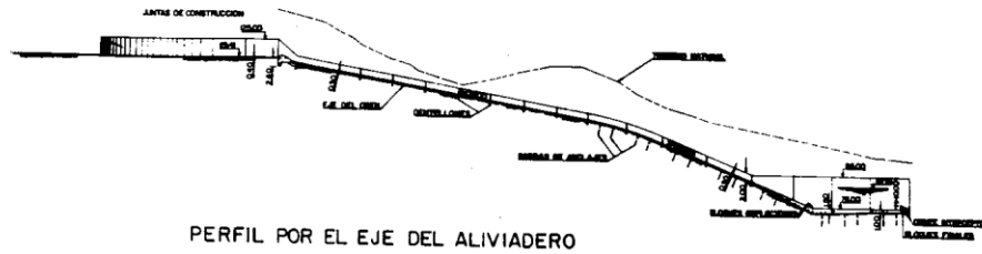
Figura A-4. Perfil Longitudinal del Aliviadero. Embalse Maticora. Fuente: Revista El Agua (1976).
