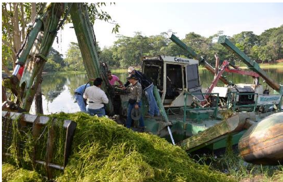
Figura 3.5. Draga multipropósito, para la recuperación total del Embalse Cumaripa. Fuente: Pagina Web del Gobierno Bolivariano del Estado Yaracuy (2014).
