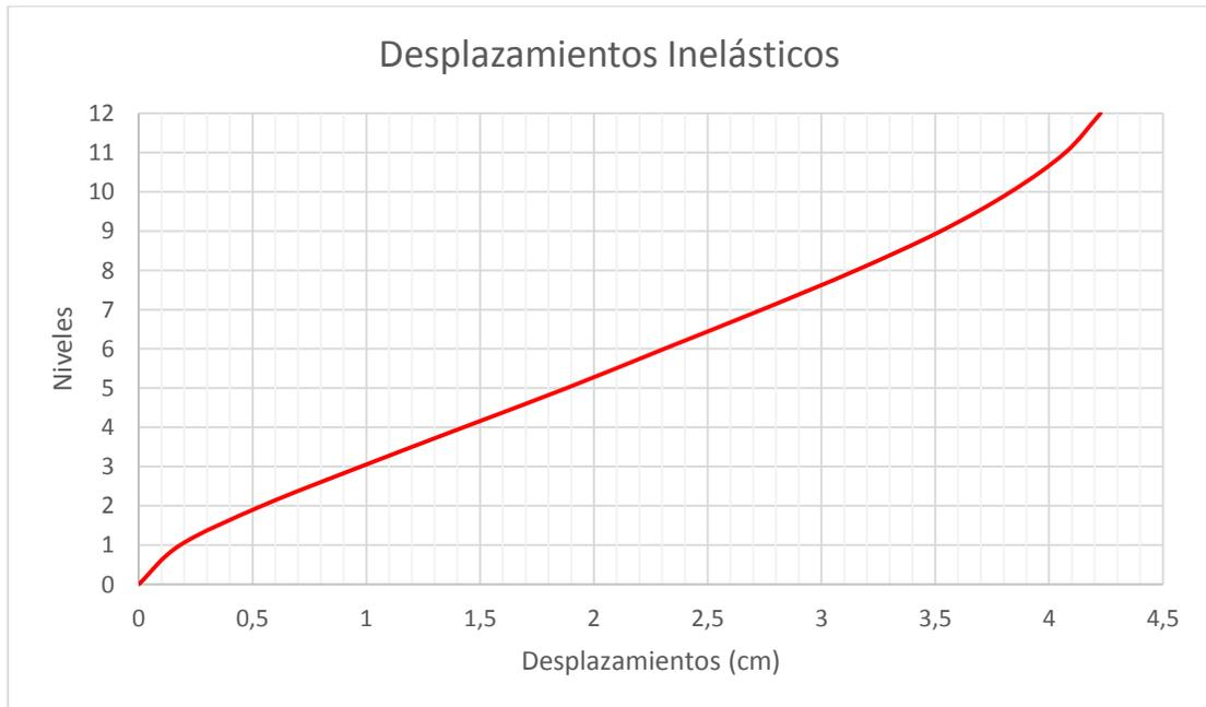
Comparación de los Desplazamientos Inelásticos de los tres modelos para 12 Niveles
