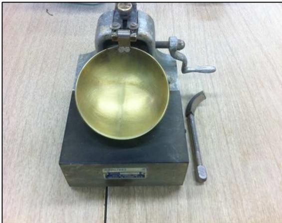
**Figura 17: Equipo de Casagrande y Acanalador en el Laboratorio. Fuente: Propia**
