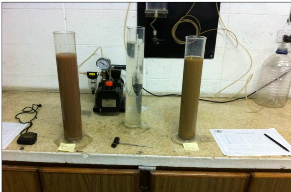
**Figura 11: Montaje de Ensayo de Hidrómetro.**
