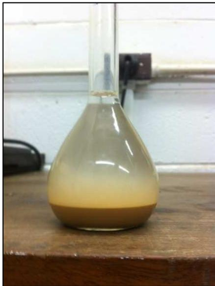
**Figura 12: Picnómetro con Muestra de Limo. Fuente: Propia**
