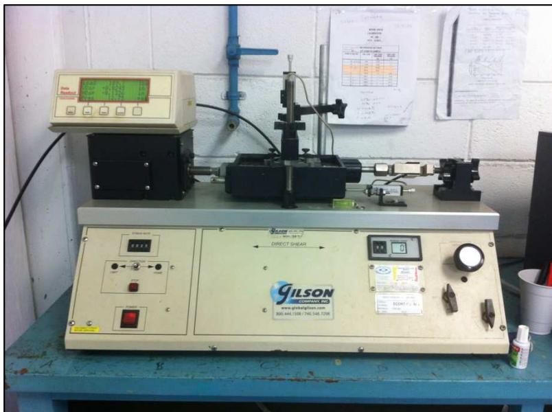
**Figura 24: Máquina de Corte Gilson. Fuente: Propia**
