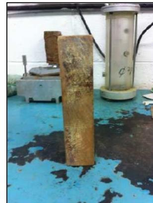
**Figura 19: Taco de Madera utilizado para compactar las muestras. Fuente: Propia**
