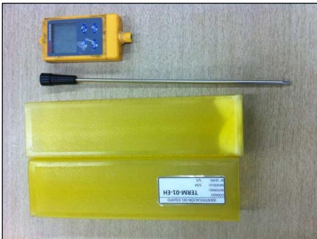
**Figura 15: Termómetro con precisión 0,1°C. Fuente: Propia**
