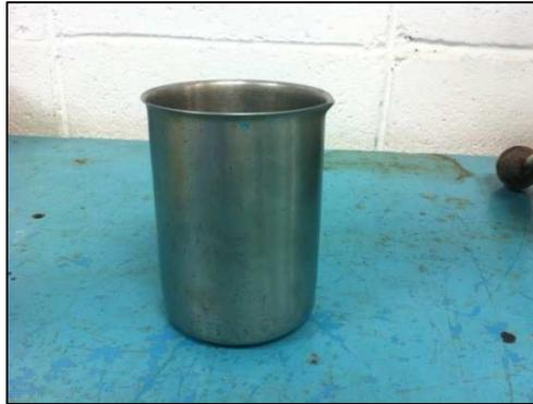
**Figura 21: Vaso donde se coloca muestra para Ensayo de Veleta de Laboratorio. Fuente: Propia**
