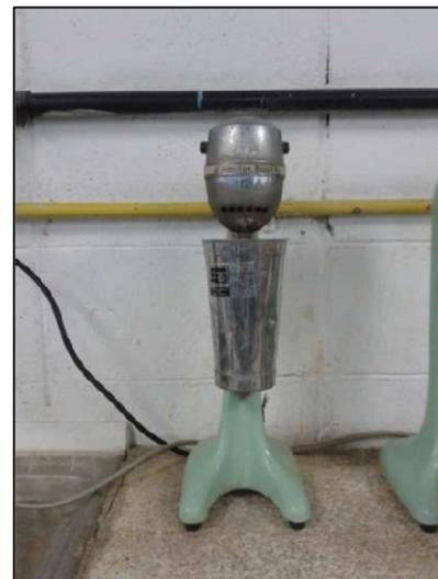
Figura 10: Agitadora Eléctrica con Vaso de Dispersión.
