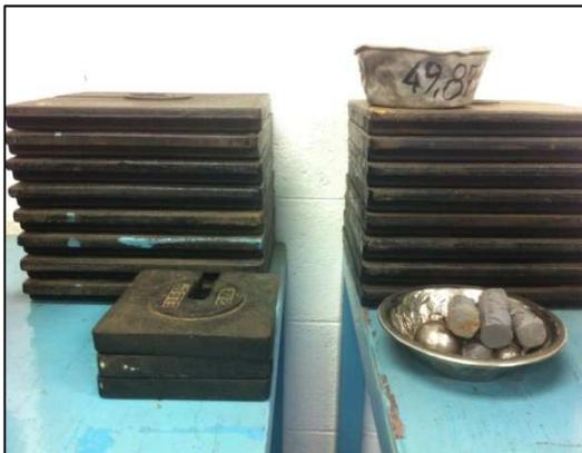
**Figura 22: Pesas Utilizadas en el Ensayo de Consolidación. Fuente: Propia**
