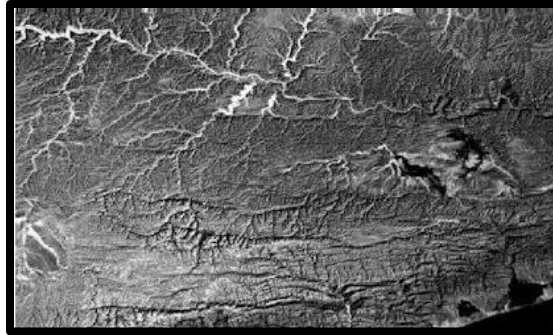
Figura 6: Patrón de Drenaje Rectangular.
