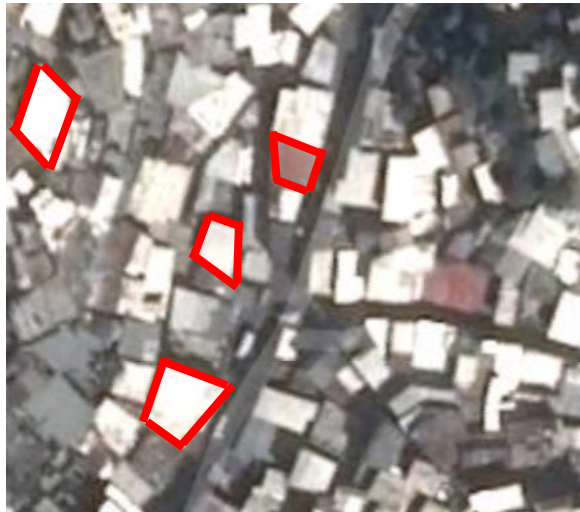
Figura 4-1: Viviendas con sistemas portantes no paralelos, Petare. (Fuente: Google Maps).
