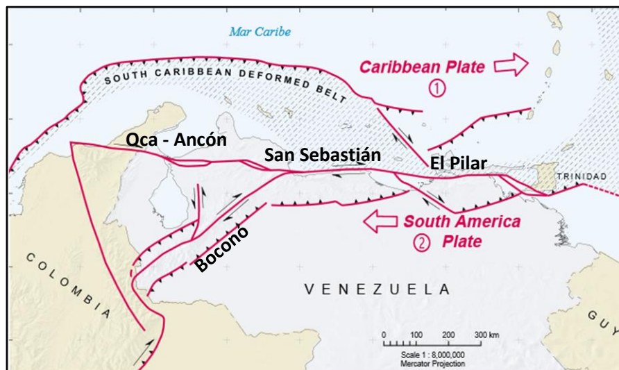
Figura 1-1: Esquema de límite de placas en Venezuela y Señalización de los sistemas de fallas principales. Zoom al centro del país. (Fuente: F. Audermard (FUNVISIS) y J. Cox y R. Dart del US Geological Survey.)
