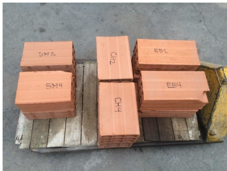
Figura 7-3: Bloques Ensayados (SM2, CH2, CH4 y EB1) y Bloques descartados (SM4 y EB4), nótese quiebre en ángulo superior derecho de bloque SM4 y quiebre en ángulo inferior derecho de bloque EB4. (Fuente propia)
