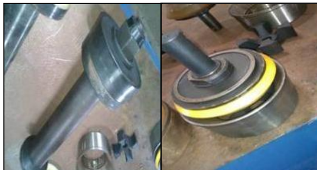
Figura 8. Conjunto de pistón y válvula fabricados en ICVT. Fuente: Olivares (2014)
