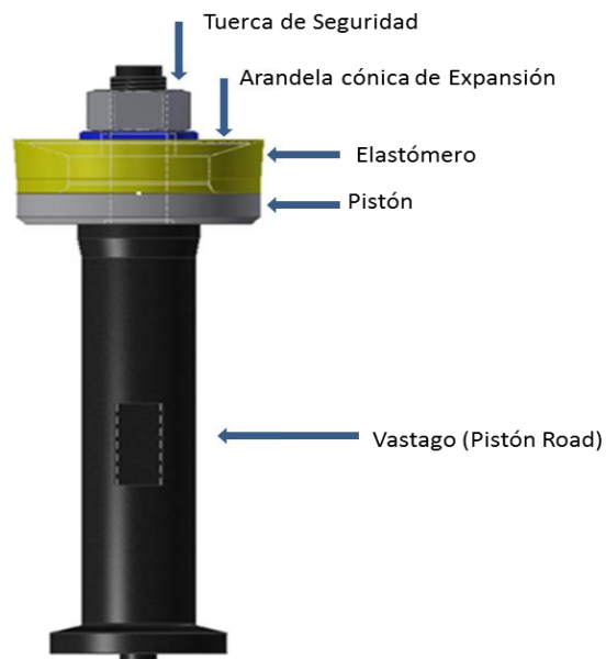
Figura 12. Conjunto de pistón de una bomba de inyección de lodo. Fuente: Olivares (2014).
