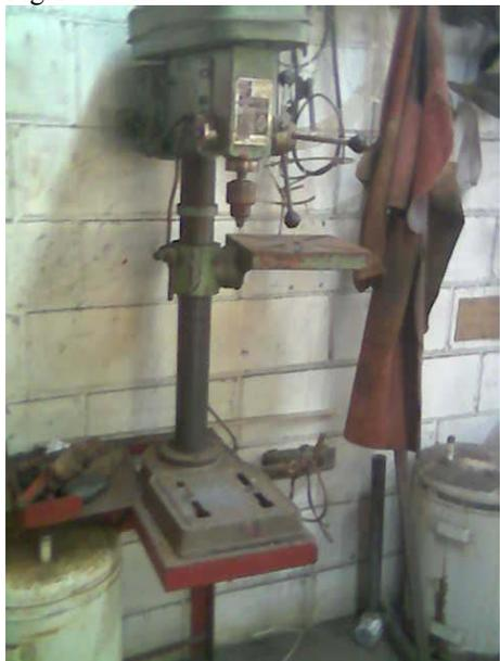
Fuente: Propia. *Taladro vertical, para realizar perforaciones en la estructura que garanticen su posterior ensamblaje.*
