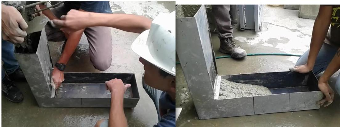
*Figura 3.3 Ensayo caja en L*
