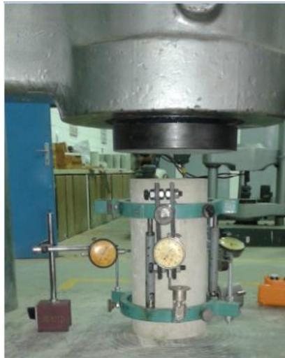
*Figura 3.4 Dispositivos de medición para ensayos a compresión*
