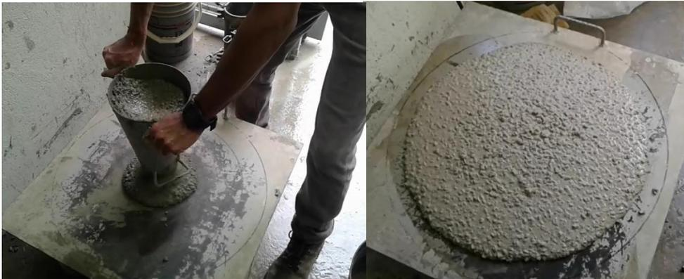
*Figura 3.1 Ensayo extensión de flujo*
