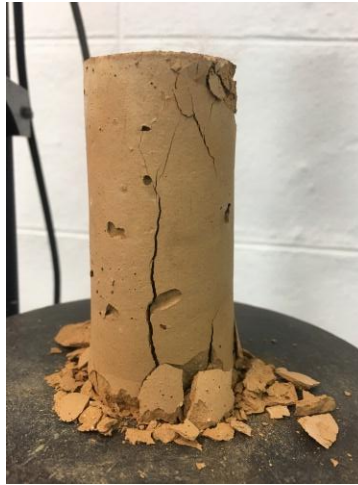
Ilustración 12. Falla Rígida. Fuente: Propia
