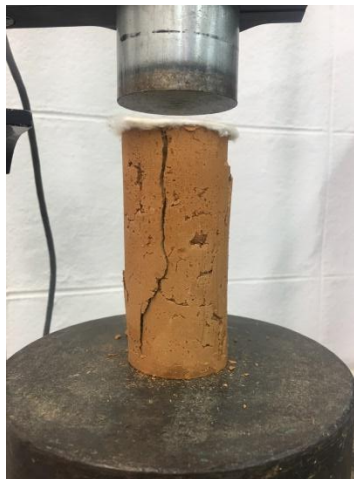
Ilustración 13. Falla Rígida. Fuente: Propia.
