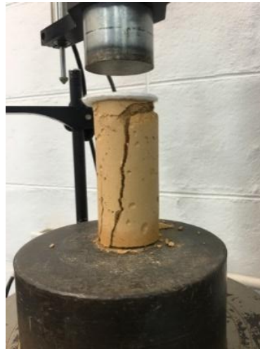
Ilustración 11. Falla Rígida. Fuente: Propia
