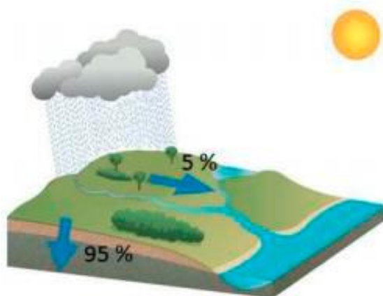
Figura 4. Reparto de Infiltración y escorrentía en una zona natural sin urbanizar.
