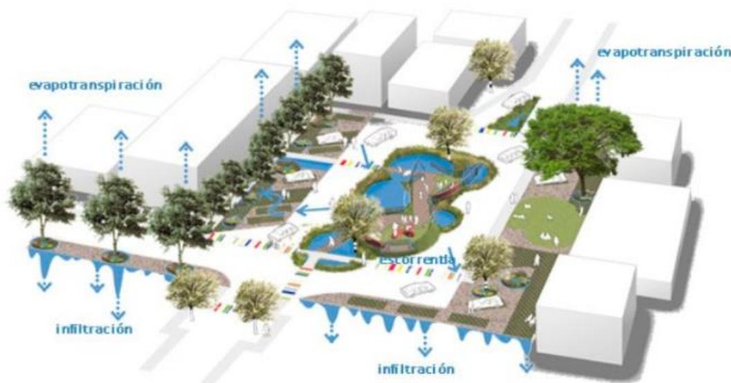
Figura 10. Bosquejo de un Sistema Urbano de Drenaje Sostenible (SUDS).
