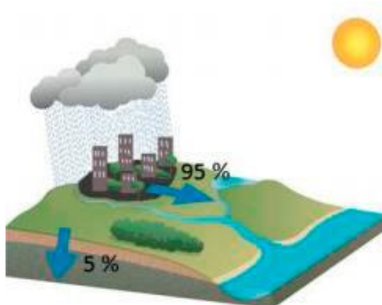
Figura 5. Reparto de Infiltración y escorrentía en una zona de baja urbanización.
