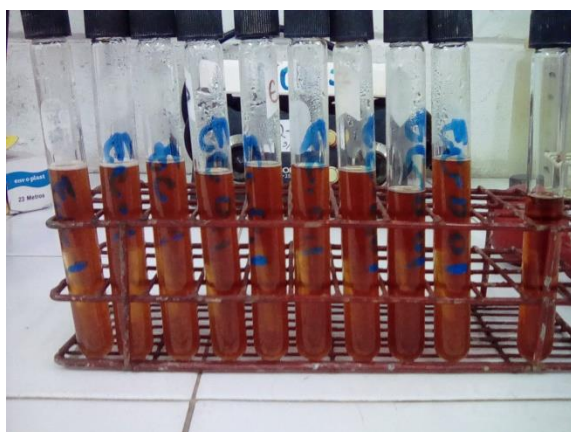
Resultado de un ensayo de Tubos Múltiples para Coliformes Fecales.
