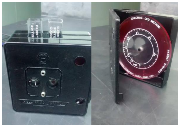
Equipo de medición de cloro residual por el método DPD.
