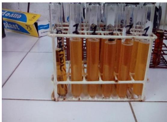
Resultado de un ensayo de Tubos Múltiples para Coliformes Totales (dilución de 1 ml y 5 tubos).
