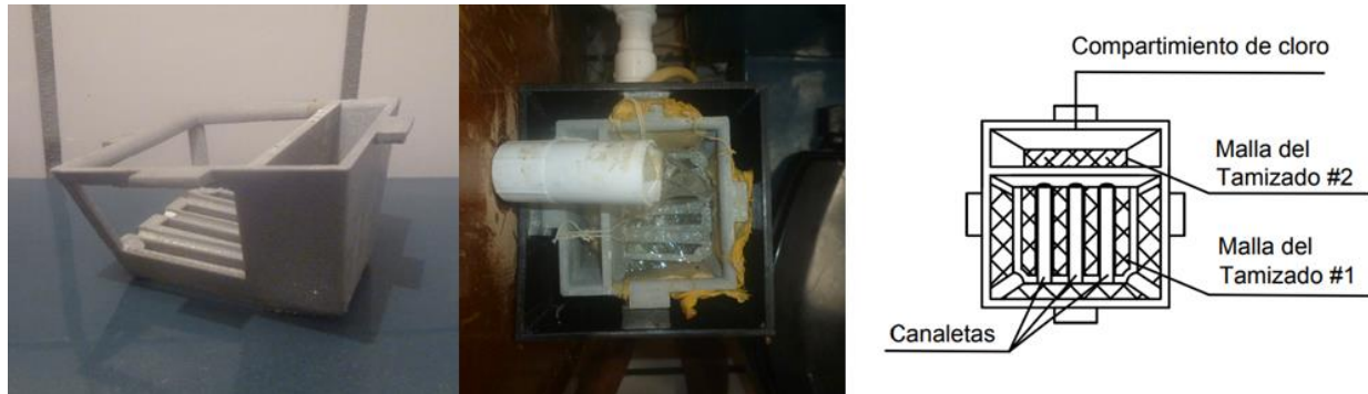
Figura 6. Estructura de Tratamiento del prototipo AquaSalvis
