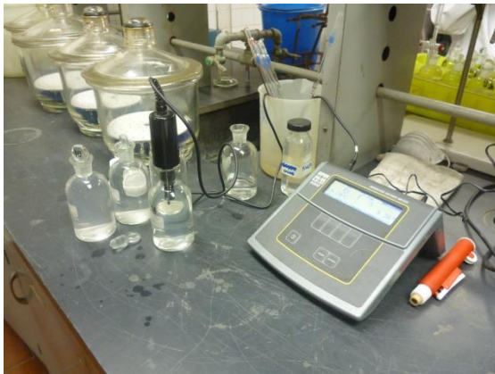
Lectura de oxígeno en muestras de DBO.
