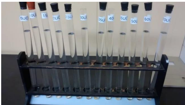
Tubos Nessler con soluciones de platino cobalto.
