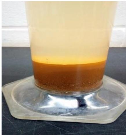
**Ilustración 13. Detalle de las Capas en Ensayo de Sedimentación.**
