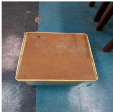
**Ilustración 11. Cámara de Curado Creada por Otaola y Ponte Sellada con Briquetas en su Interior.**
