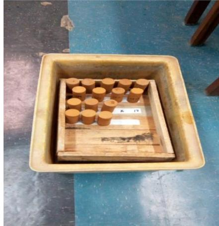
**Ilustración 10. Cámara de Curado Creado por Otaola y Ponte con Briquetas en su Interior.**
