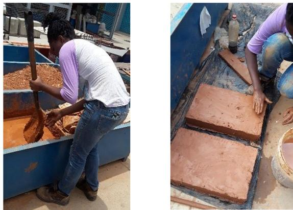
*Figura 6. Amasado y fabricación de bloques.*
