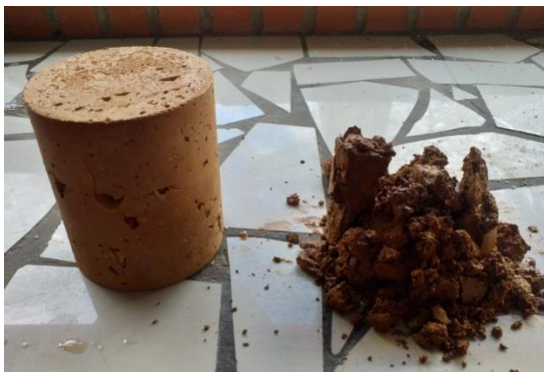
Ilustración 1 Disgregabilidad Briqueta Suelo Natural
