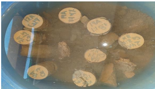
Ilustración 3 Disgregabilidad Briquetas Suelo Arcilloso Estabilizada
