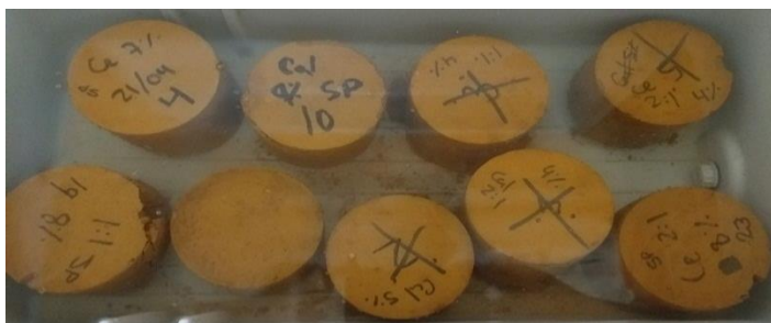
Ilustración 4 Disgregabilidad Briquetas Suelo Limo Arcilloso Estabilizado
