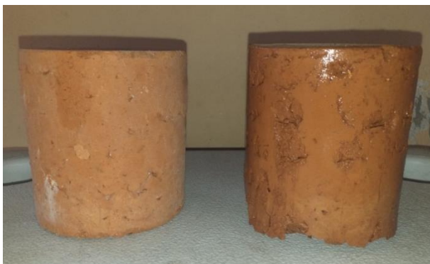
Ilustración 2 Disgregabilidad Briqueta Suelo Estabilizado
