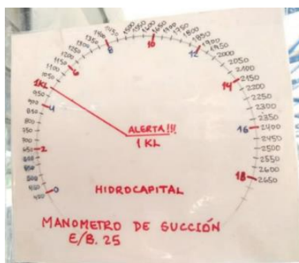
Figura N°29. Escala con la que se lee el manómetro de succión.
