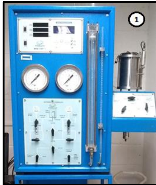
Figura II- 2 Equipo triaxial ( Fuente: propia, laboratorio AIG c.a )
