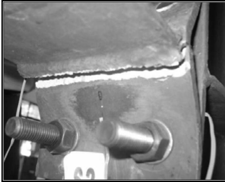
**Figura 40: Ruptura del ala traccionada de la viga en la zona soldada de la plancha extrema.** Fuente: Jayachandran, A. (2009).
