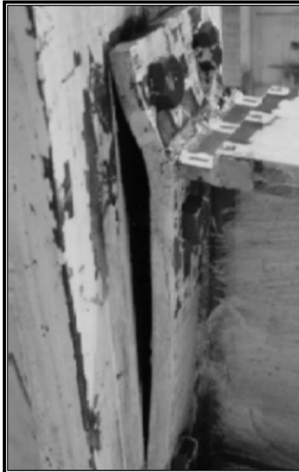
**Figura 38: Flexión por cedencia de la plancha extrema.** Fuente: Girão, A. (2004).
