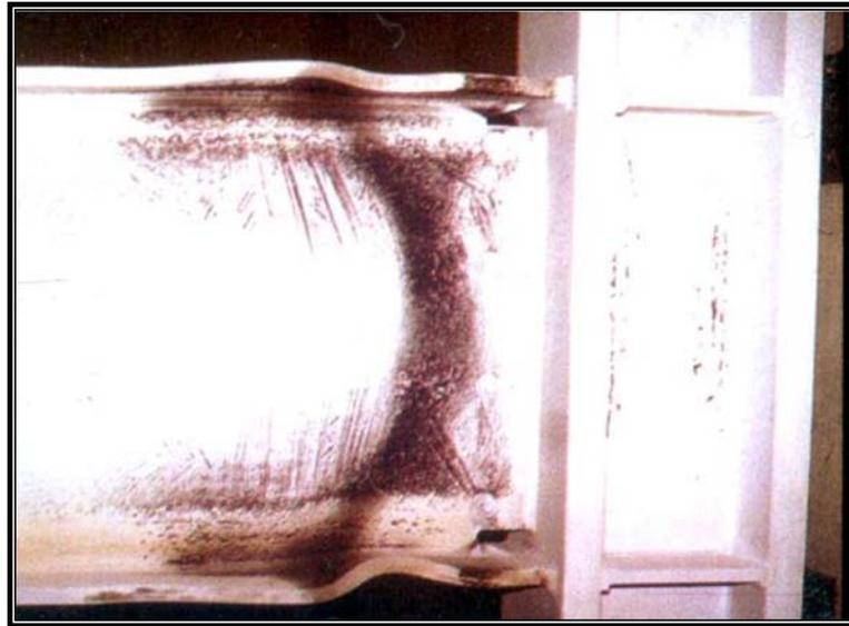
**Figura 8: Rotula plástica formada por la plastificación del extremo de una viga. Fuente: Crisafulli, F. (2014).**
