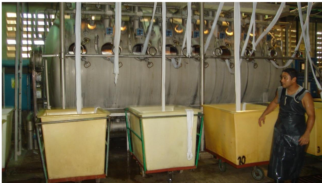
Figura 30 Descarga de tela en la maquina Gaston de 1200kg. Fuente: Elaboración propia.
