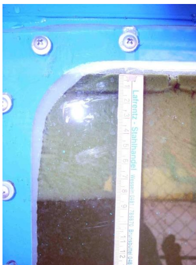
Imagen N° 10 Medición de profundidad del manto flotado
