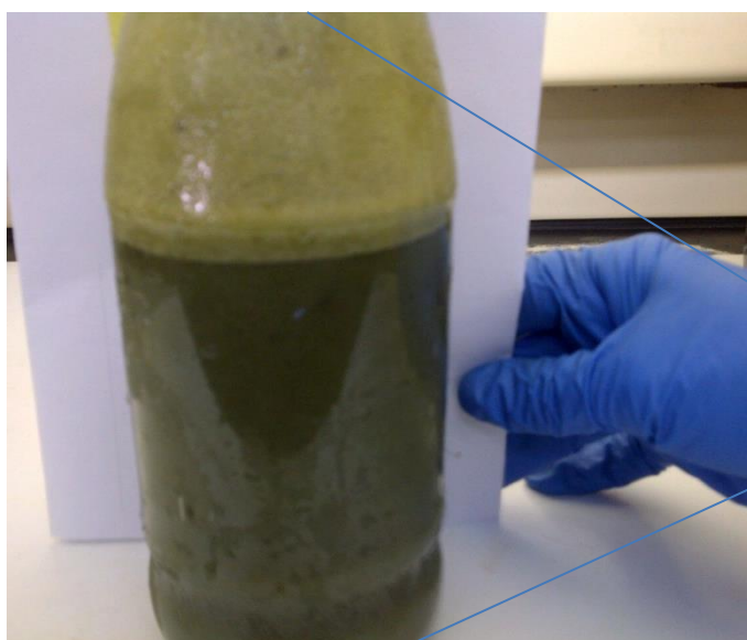
Imagen N° 14 Nata de flotación previo al análisis de laboratorio, específicamente en la determinación de los parámetros físico químicos Fósforo Total, Fósforo Reactivo Disuelto y Fósforo Disuelto Total
