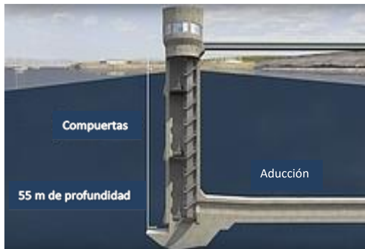
Fig N° 12 Estructura de un embalse con su correspondiente torre toma. Imagen modificada de http://www.abc.es/espana/madrid/abci-torres-gemelas-para-extraer-energia-embalse-valmayor-201603102233_noticia.html .
