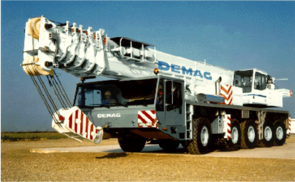
**Figura 3.** Fotografía de grúa móvil telescópica.
