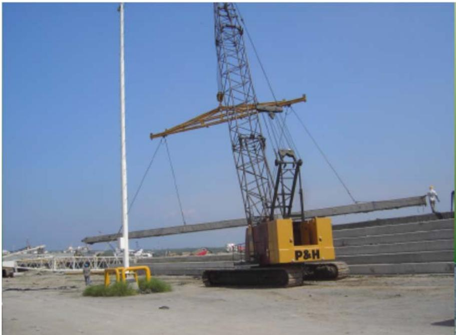
**Figura 4.** Fotografía de grúa móvil de celosía y sobre orugas.
