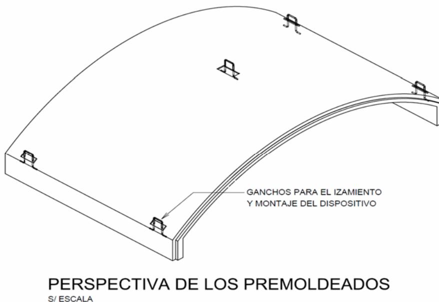
**Figura 2.** Isometría de los premoldeados tipos 1 y 2.
