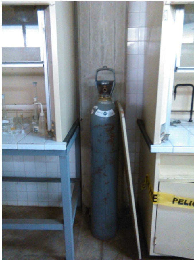
Cilindro sin sujeción a punto fijo
