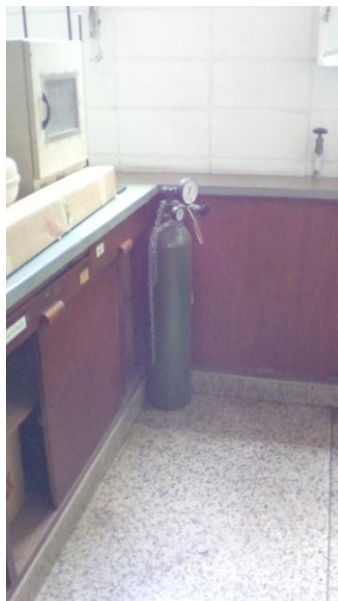
Mala disposición de cilindro de gas comprimido (mal ubicado y no sujeto a punto fijo)
