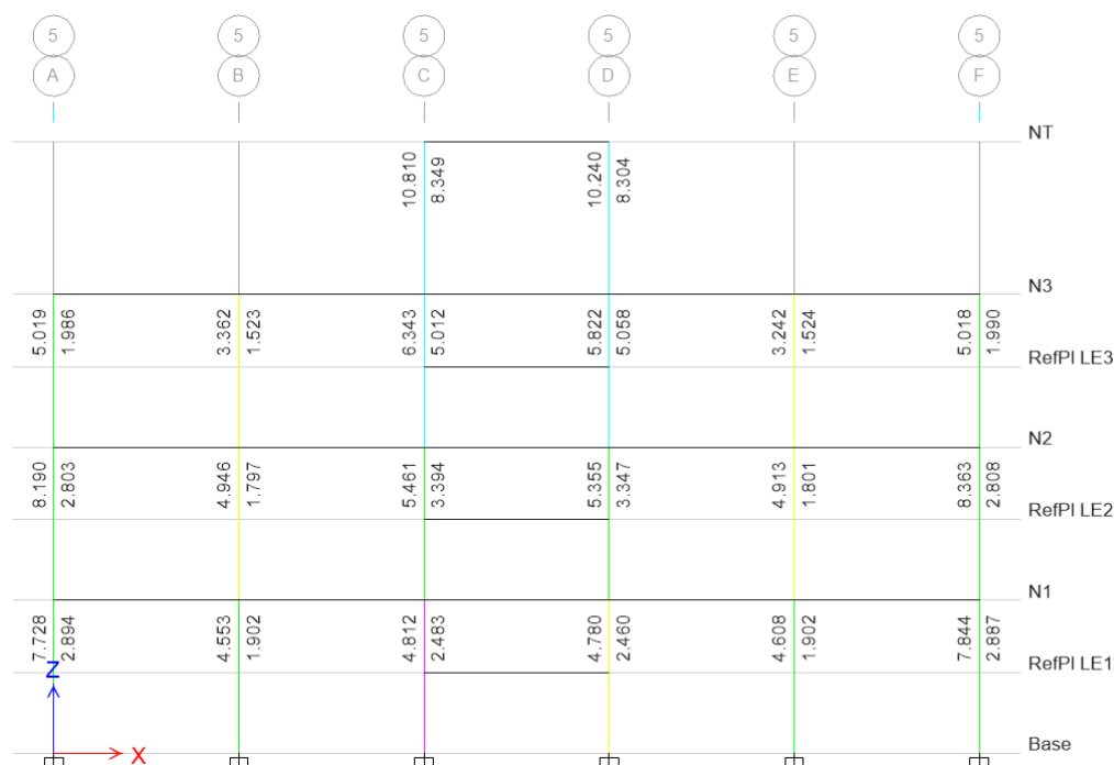
Figura 163. Revisión Columna Fuerte – Viga Débil, Pórtico 5 – Caso 6.
