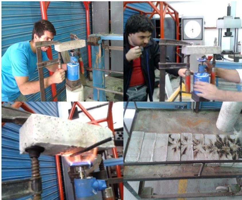
Figura 3-19. Ensayo de flamabilidad del concreto
