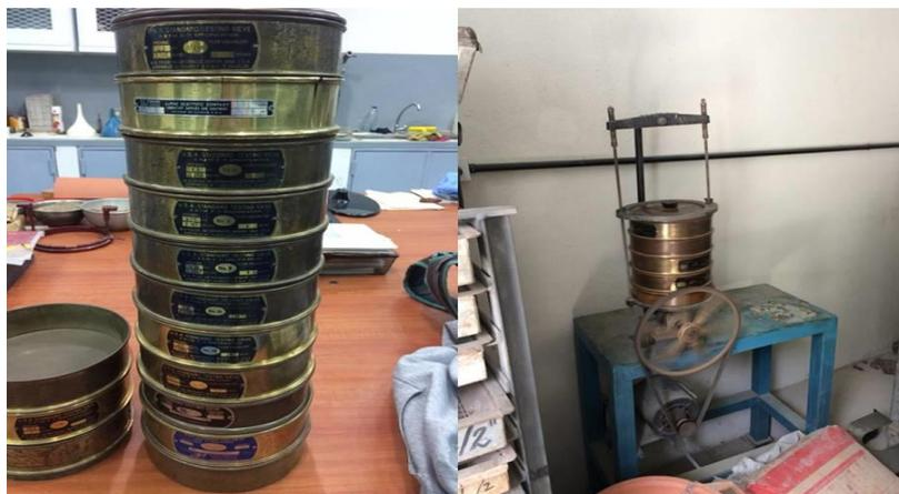
Figura 3-6. Ensayo de granulometría
