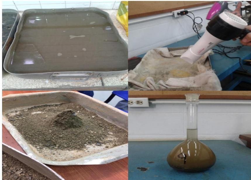
*Figura 3-7.* Ensayo de densidad y absorción del agregado fino
