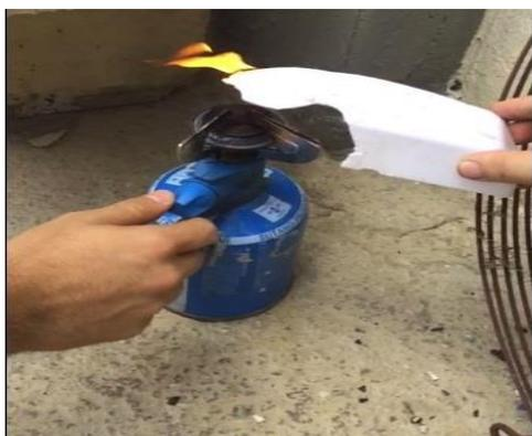
Figura 3-20. Ensayo de flamabilidad del plástico inicial
