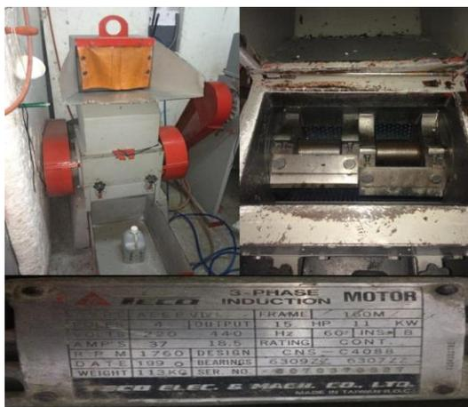
Figura 3-4. Máquina trituradora
