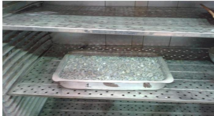
*Figura 3-10.* Ensayo de humedad para agregados convencionales
