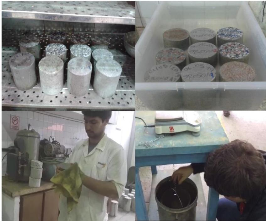
Figura 3-18. Ensayo de absorción de agua del concreto endurecido
