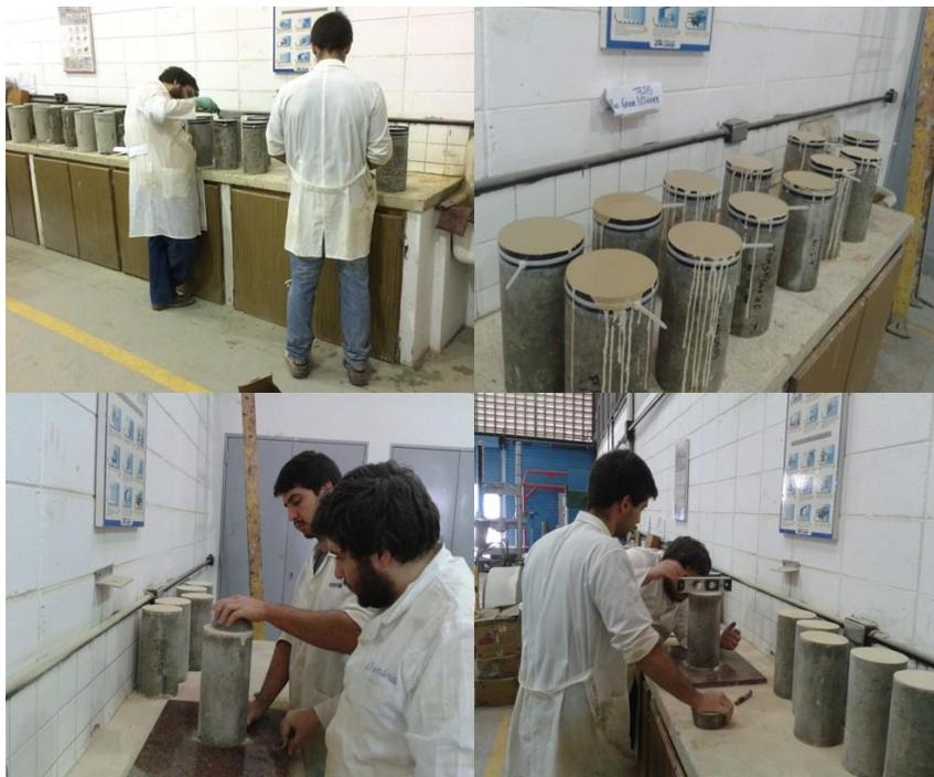
*Figura 3-16.* Proceso de refrentado de cilindros
