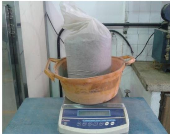
*Figura 3-11.* Pesaje de los agregados
