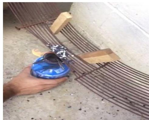
Figura 3-21. Ensayo de flamabilidad del plástico triturado
