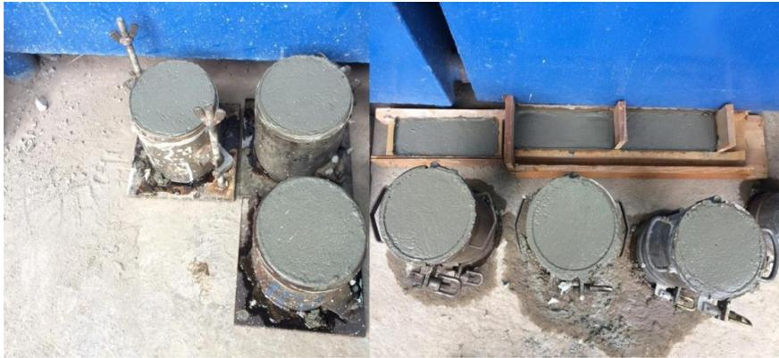
*Figura 3-14.* Especímenes terminados luego del proceso de llenado
