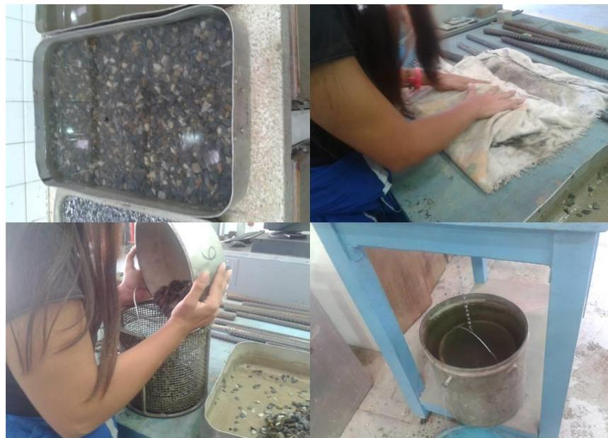
*Figura 3-8.* Ensayo de densidad y absorción del agregado grueso
