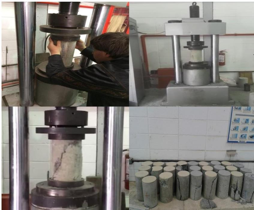
Figura 3-17. Ensayo de resistencia a la compresión
