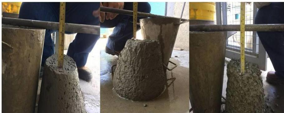
Figura 3-13. Medición del asentamiento
