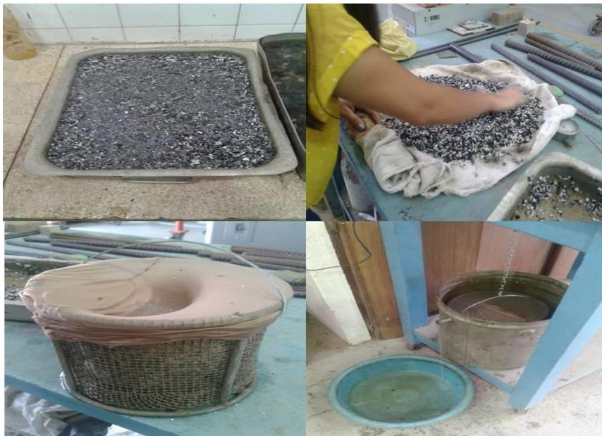
Figura 3-9. Ensayo de densidad y absorción del plástico triturado
