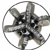
12 ¼", mecha de cuerpo de acero, 6 blade , 54.3 in² JSA (46 %)
