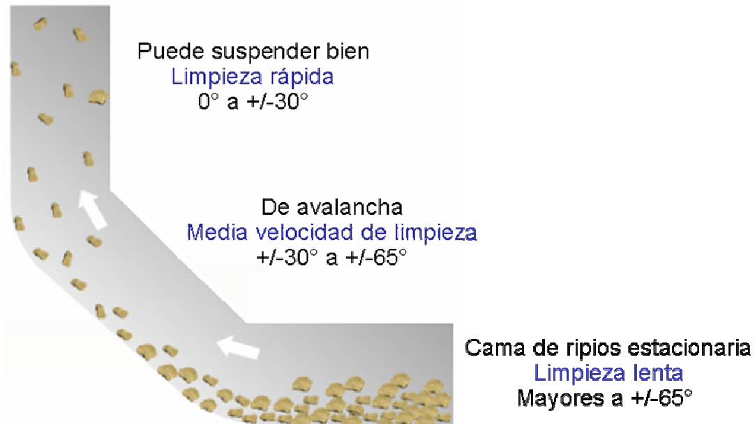
Figura 6. Comportamiento de los ripios dependiendo del ángulo del hoyo
