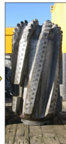
12 ¼", mecha de cuerpo de acero, 6 blade , 54.3 in² JSA (46 %)
