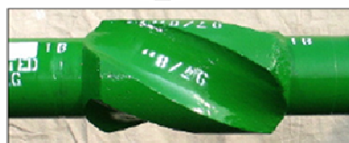
Como un estabilizador integral ve un hoyo de 12 ¼" (OD del cuerpo 8")
