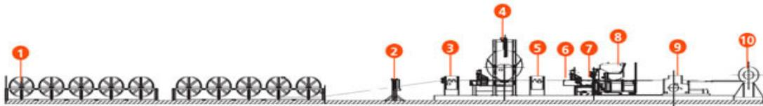
**Figura 33.** Planta automática para elaboración de mallas electrosoldadas de acero estructural. Fuente: Schnell (2016)
