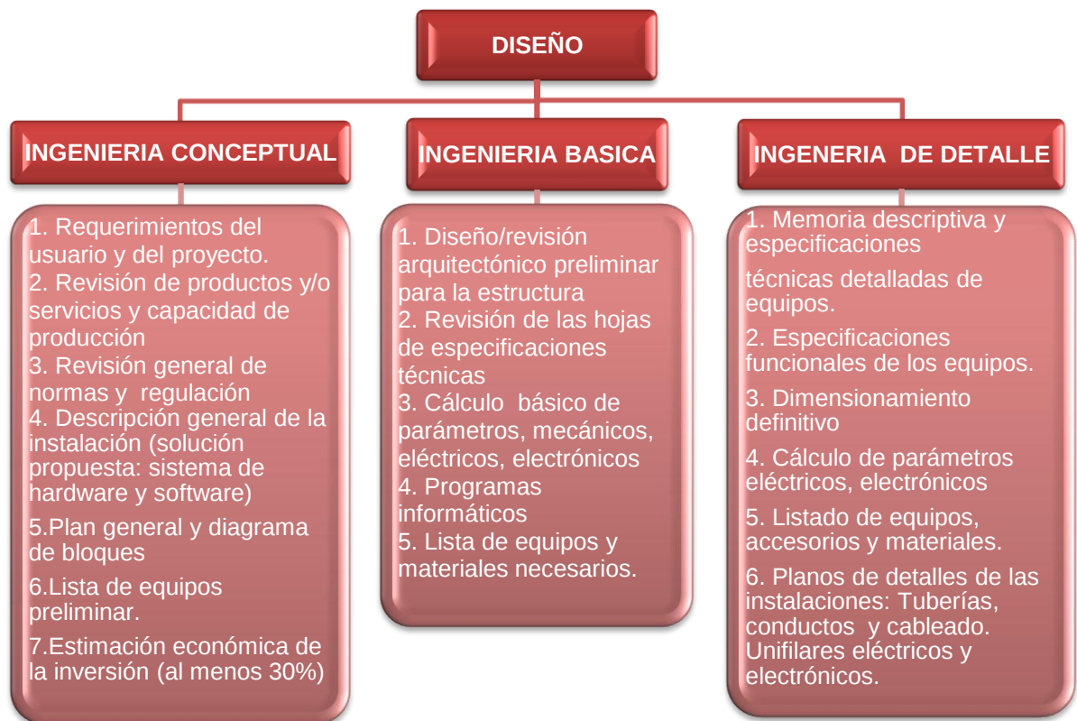
Figura n°13. Esquema descriptivo del diseño del proyecto
