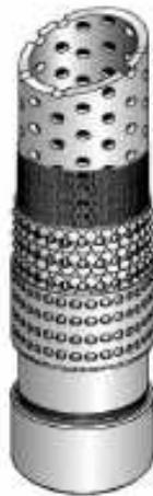
Figura 6. Rejilla de malla metálica
