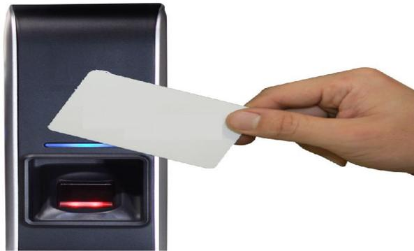
Figura 11: Lector biométrico y de proximidad para control de accesos
