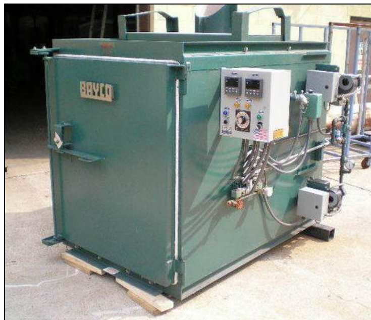
Figura 43: Horno para limpieza de compresor
