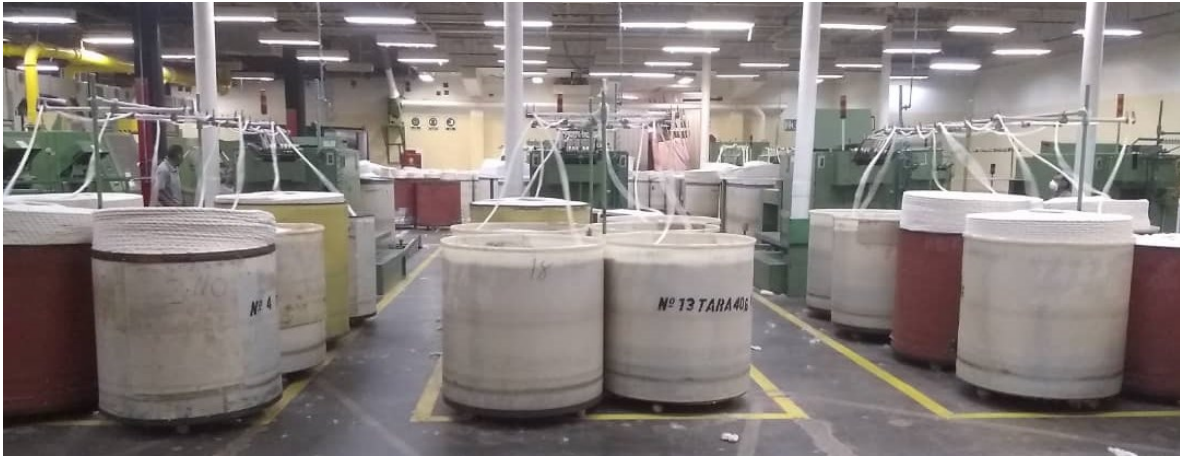
Figura 11 Potes de cardas siendo procesados en los manuales Fuente: propia
