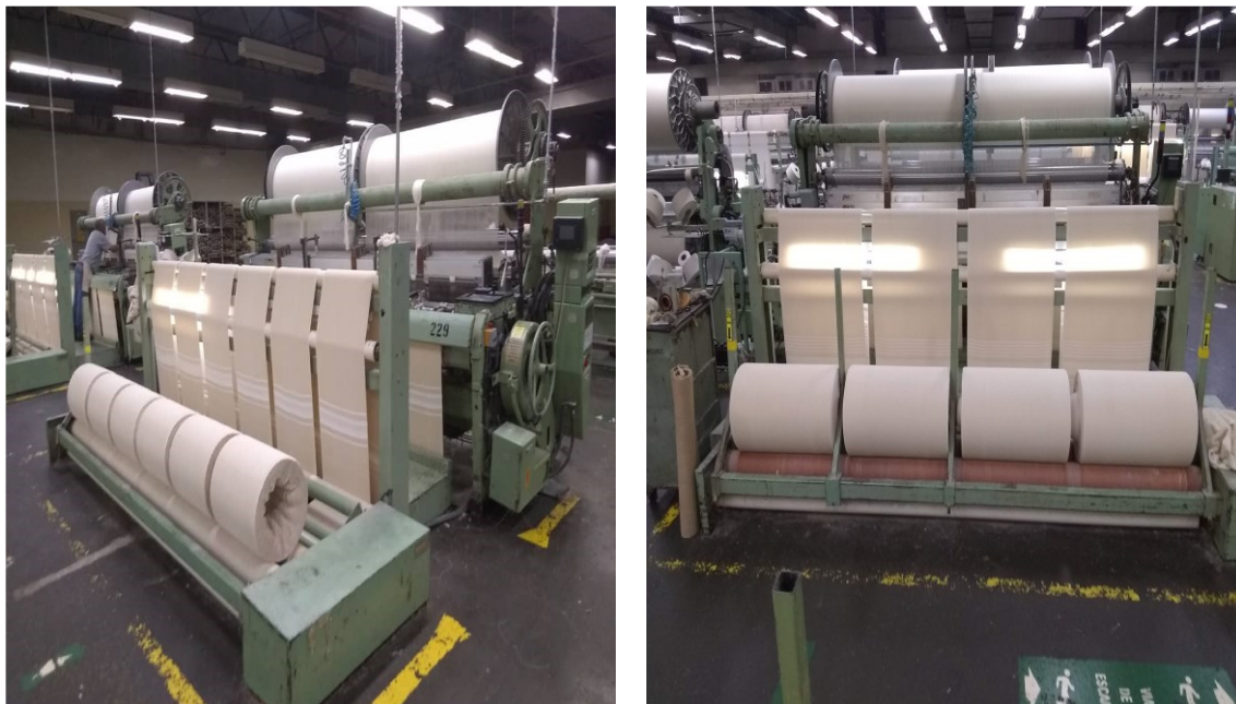
Figura 5 Telar en producción Fuente: propia
