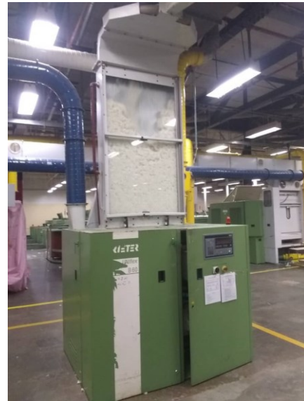
Figura 20 Uniflex en operación Fuente: propia
