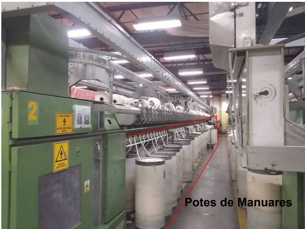
Figura 12 Potes de manuales en la sección Open End Fuente: propia
