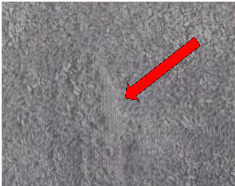
Figura 3 Toalla con el defecto "hilo roto" producto terminado Fuente: propia
