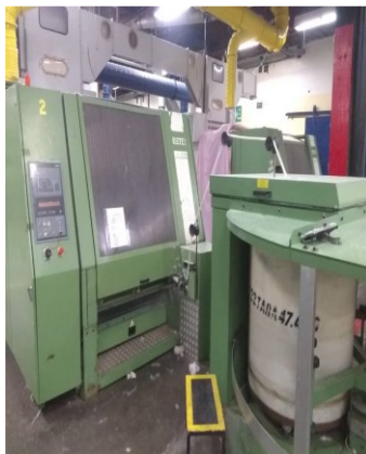
Figura 10 Línea de cardas Fuente: propia
