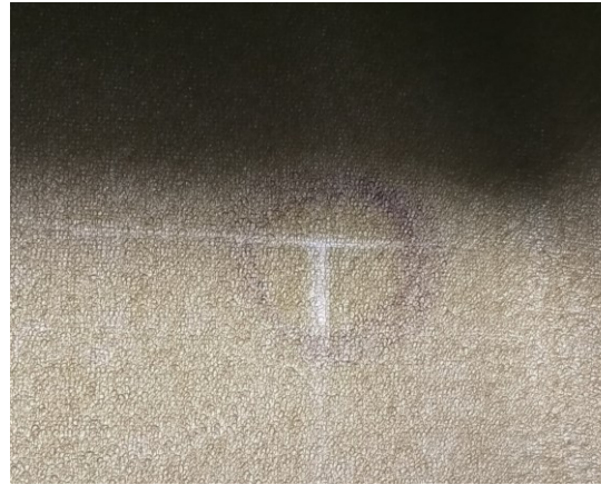
Figura 2 Hilo roto en un rollo de toalla Fuente: propia
