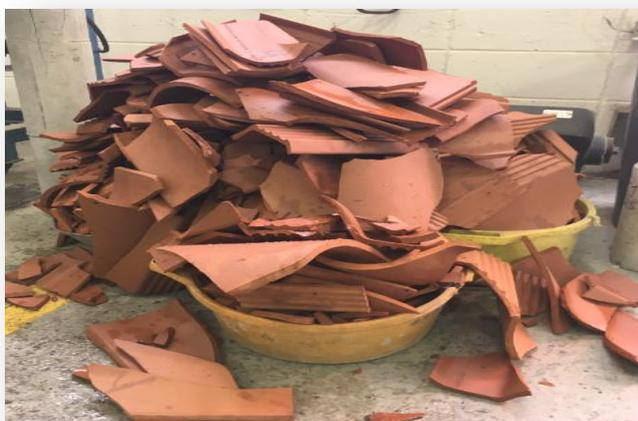
Según la ASTM C1167 – 03, norma imperante en el mercado interesado, cualquier teja curva debe tener una resistencia mínima a flexión de 100 kgf.
