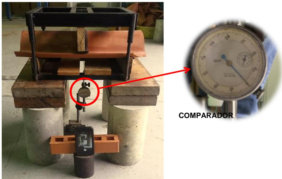
**Figura III-5:** Montaje de equipo de carga
