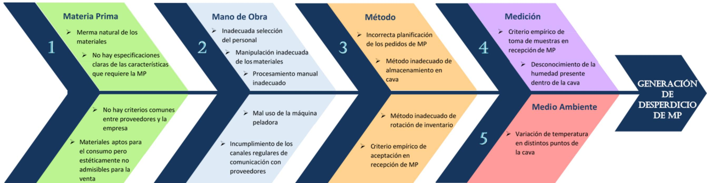
Figura 12: Diagrama causa - efecto de la generación de desperdicio de MP
