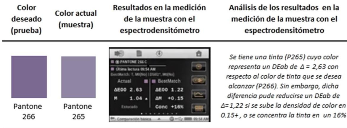
Figura 32. Representación gráfica del funcionamiento de un espectrodensitómetro.
