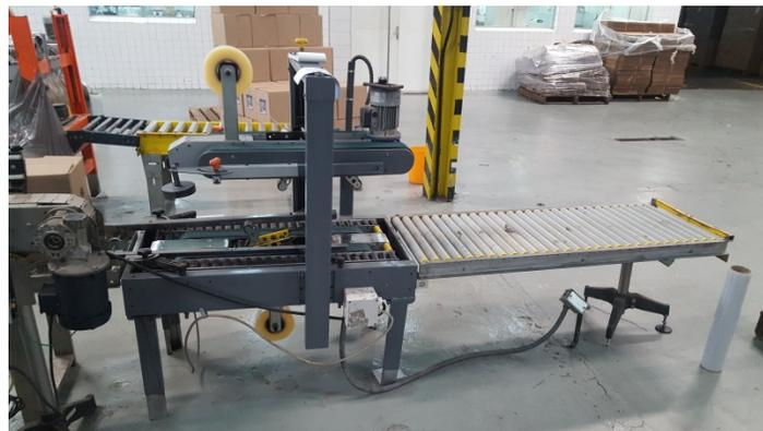
**Figura 23:** Equipo para sellado de Cajas de la Línea 2
