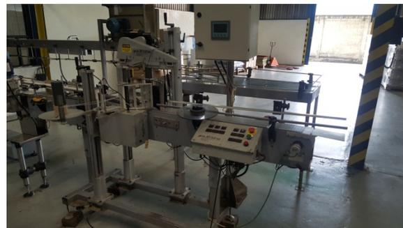
**Figura 21:** Etiquetadora de la Línea 1
