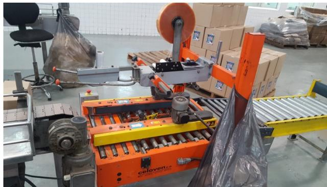
**Figura 22:** Equipo para sellado de cajas de la Línea 3
