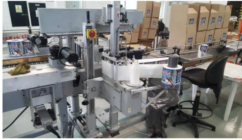
**Figura 19:** Etiquetadora de la Línea 3
