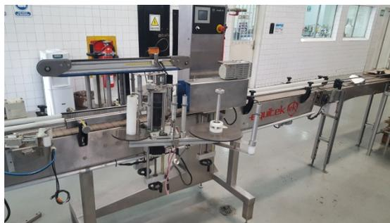
**Figura 18:** Etiquetadora de la Línea 4
