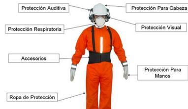
*Ilustración 13: Implementos de protección para trabajos en Tornos*
