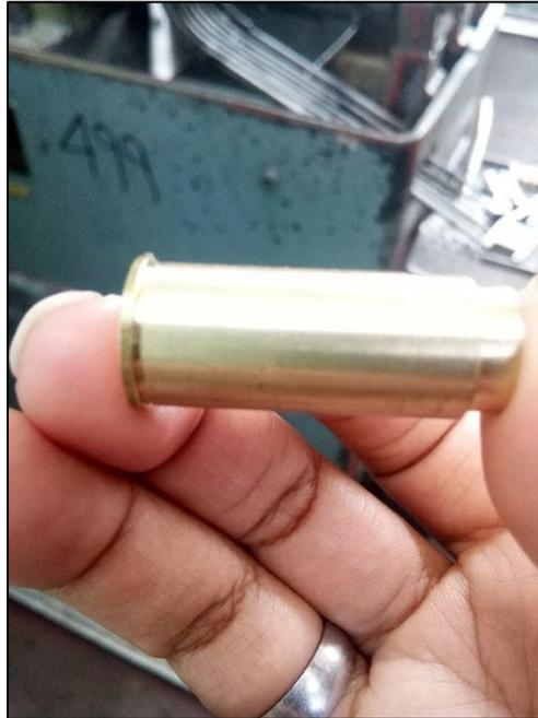
*Ilustración 33: Perno elaborado en torno 499*
