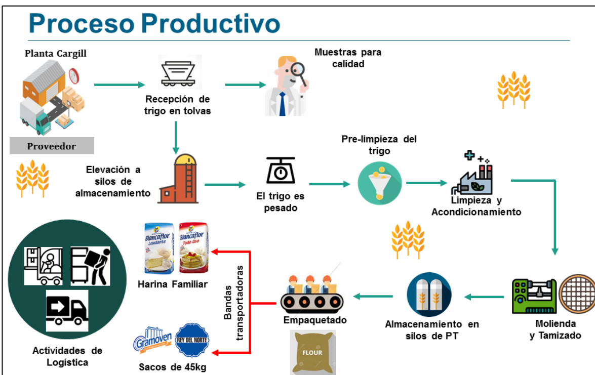
Figura 2. Diagrama de flujo del proceso productivo.
