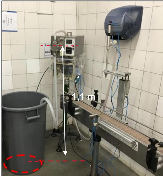
Figura 28: Evidencia de diferencia de altura entre el tanque y la bomba de la llenadora.
