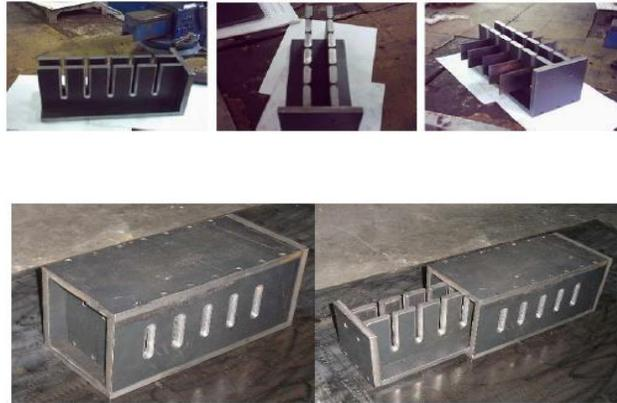
Figura 9 Disipador tipo Caja Metálica
