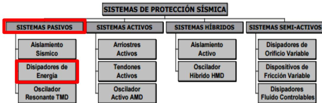
Figura 2. Clasificación de los Sistemas de Protección Sísmica
