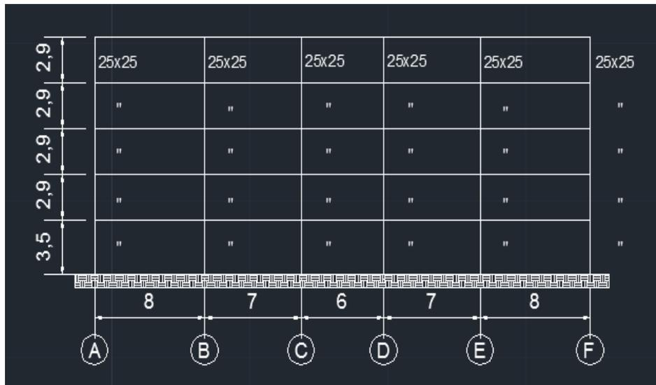
Figura 23. Vista Frontal de la estructura, pórticos 1 y 4. Vigas 30x60
