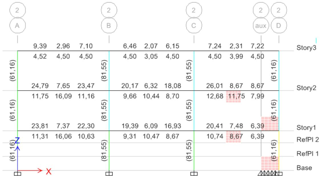
Figura N° 73 Acero de Refuerzo Pórtico 2, Modelo S2
