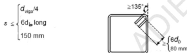
Figura N° 26 Detalle de Estribos
