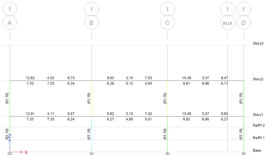
Figura N° 53 Acero de Refuerzo Pórtico 1, Modulo S2(0.70)
