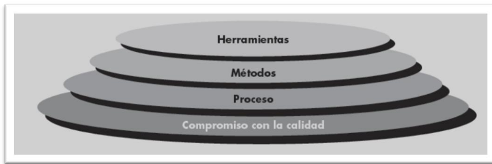
Figura N° 8. Capas de la ingeniería de software Fuente: Pressman (2010)
